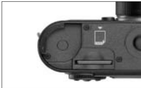
3. Ponga en la ranura (1.40) la tarjeta de memoria con los contactos hacia atrás y con la esquina biselada señalando hacia abajo. Desplácela contra la resistencia de resorte totalmente hacia atrás hasta que encastre perceptiblemente.
