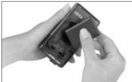
3. Coloque un acumulador con sus contactos abajo y con su lado marcado con una flecha señalando oblicuamente hacia abajo en el compartimento de carga (1.41) del cargador.
