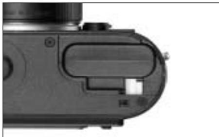
3. Colocar el acumulador con sus contactos delante del compartimento. Presiónelo en el compartimento (1.38) hasta que la corredera de bloqueo, de color blanco, con resorte (1.39) se deslice sobre el acumulador ptegiéndolo.
