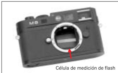
La LEICA M8 determina la potencia del flash mediante el encendido de uno o varios flashes de medición en décimas de segundo antes de la auténtica toma. Inmediatamente después, al comienzo de la exposición, se enciende el flash principal. Todos los factores, que influyen sobre la exposición (p. ej. filtro de toma y modificaciones del ajuste del diafragma), se tiene automáticamente en cuenta.
